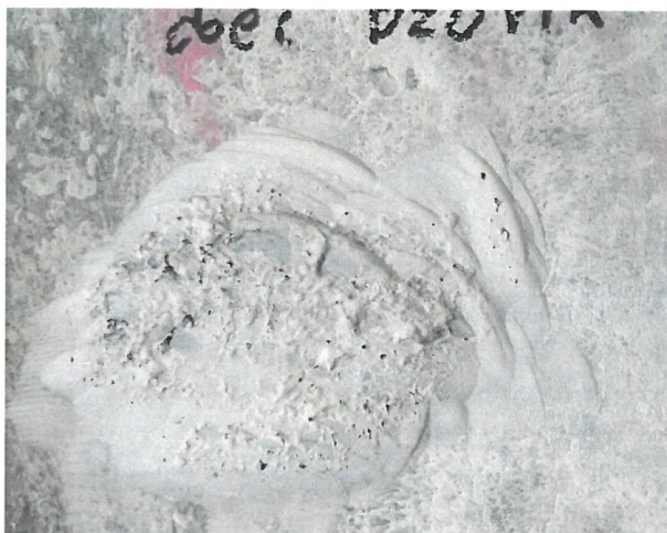
Obrázok 23 Očistené miesto pre skleroskopickú skúšku
